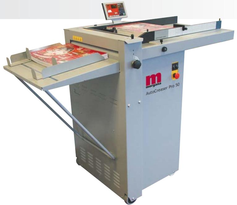
AutoCreaser Pro 50は Morgana社の新しい位置決めシステムを備えています。ドラムによる送り動作が始まる前に、シートが真空で引っ張られると、ドラムは回転し、シートを送り、真空を解除します。この大きな機構変更で、フィーダ部に高くシートを積み重ねることができ、多く残っているシートをすべて送ることができます。
