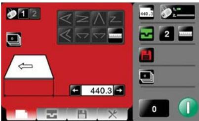
スクリーンを使用するのは簡単です。シート長(典型値はデフォルト設定)をキー入力し、最終仕上り形(レターなど)を設定し、ボタンを押して実行します。AutoCreaser Pro 50は自動でクリースすべき場所を計算し、実行します。
