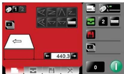
スクリーンを使用するのは簡単です。シート長(典型値はデフォルト設定)をキー入力し、最終仕上り形(レターなど)を設定し、ボタンを押して実行します。AutoCreaser Pro 33は自動でクリースすべき場所を計算し、実行します。
